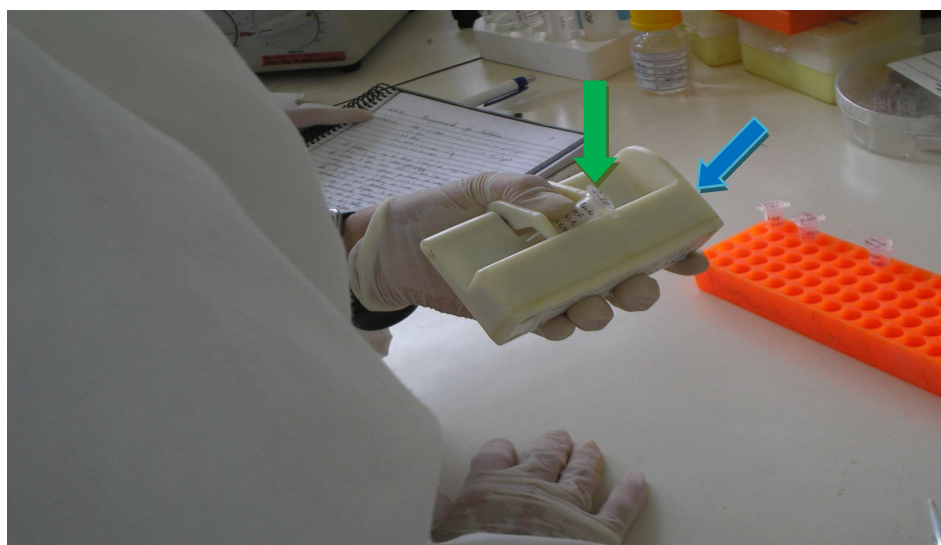
Figura 10 – Na seta azul o ímã utilizado para separar as contas magnéticas (beads) das soluções aquosas. Na seta verde o eppendorf com a solução.
